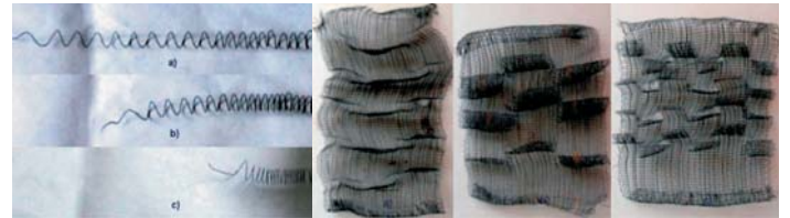
Şekil 15. Şekil hafızalı telin ve şekil hafızalı tel içeren kumaşın, zaman içerisinde sıcaklıkla şekil değişimi T=50°C: (a) 0 s; (b) 10 s; (c) 20 s [54]
