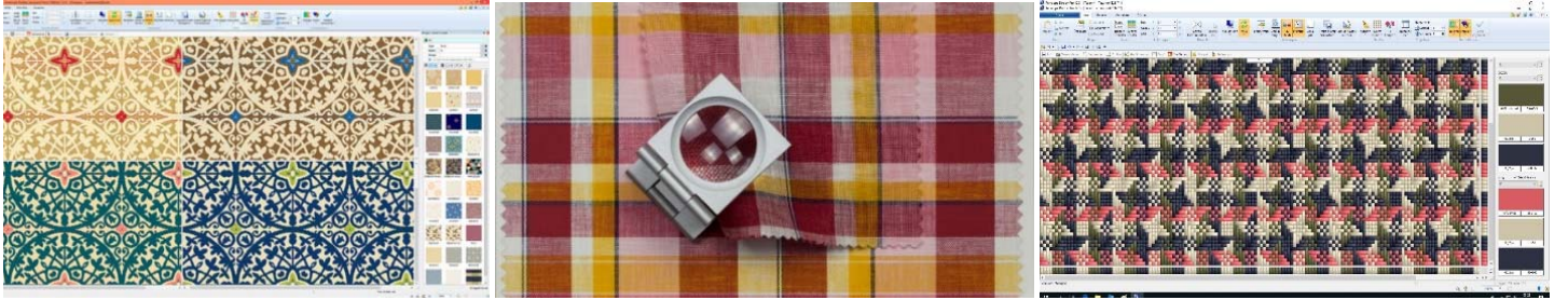
Şekil 21. Varyant oluşturma, gerçeğe en yakın görünümde çıktı özelliği ve kumaş simülasyonu [27, Başaran, 2018]
